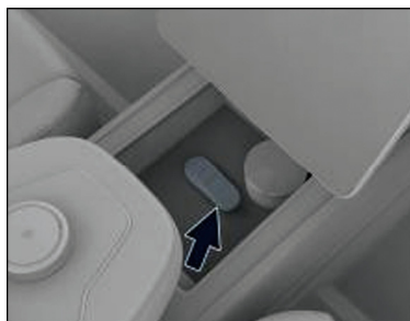
موقعیت قرارگیری کلید ریموت در حالت اضطراری
