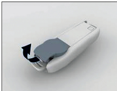
تصویر: باز کردن قاب عقب کلید
