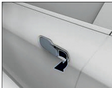
تصویر: باز کردن قفل با دستگیره بیرونی درب
