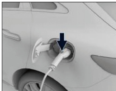
تصویر: اتصال کابل شارژ
