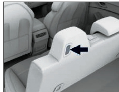
مکانیزم باز کردن قفل در قسمت پشت پشت‌سری‌های بیرونی عقب قرار دارد
