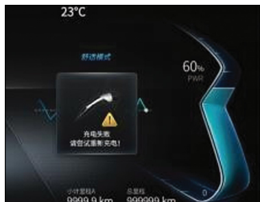
تصویر: نمایش خطای شارژ در پنجره پاپ‌آپ پشت‌آمپر
