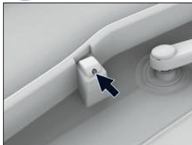
تمیز کردن سر نازل شیشه‌شوی
